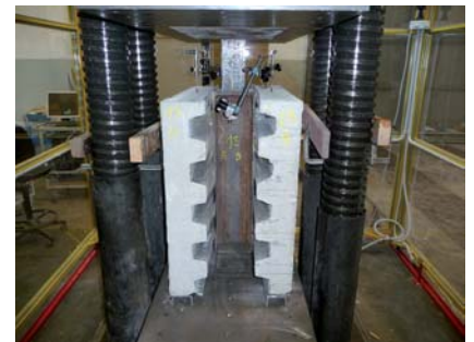
Test de Poussée Normalisée réalisé par l'Université des Ingénieurs de Padoue en Italie et par le laboratoire interne TECNARIA.
