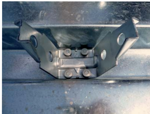
Test de Poussée Normalisée réalisé par l'Université des Ingénieurs de Padoue en Italie et par le laboratoire interne TECNARIA.
