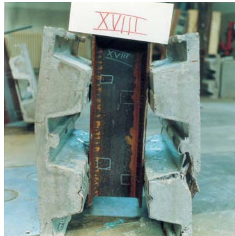
Fig. 27 Affaissement des échantillons type C4-C5 27
