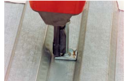
Figure 6 Cloueuse : détail du nez magnétique
