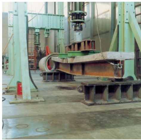
Fig. 31 Échantillon T1 sous la charge d'essai 31
