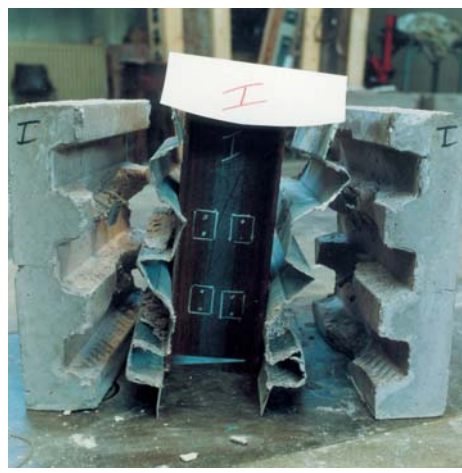
Fig. 26 Affaissement des échantillons type C2-C3 26
