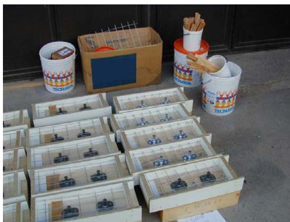
Photo 1 : Détail des coffrages, des connecteurs et du treillis métallique d'armature
