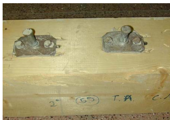
Photo 5 Fluage des connecteurs à la fin de l'essai
